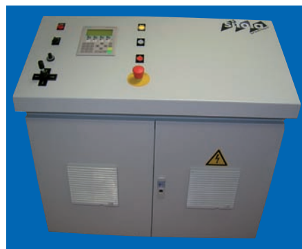
Abb. 8: Neues Bedienpult einer Vertikalschneidemaschine
