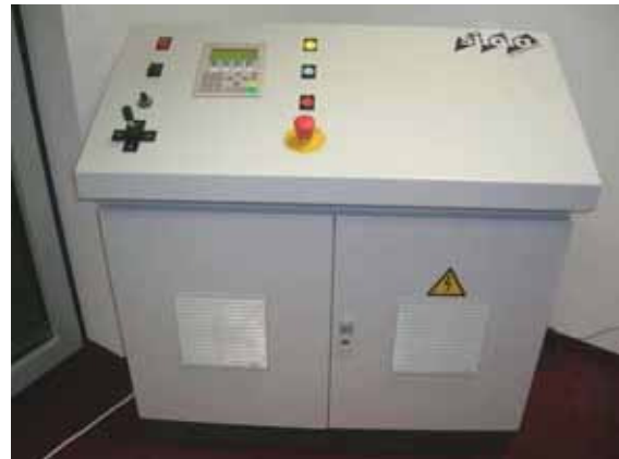
Abbildung 9: Neues Bedienpult einer Vertikalschneidemaschine Quelle: Eigene Aufnahme.
