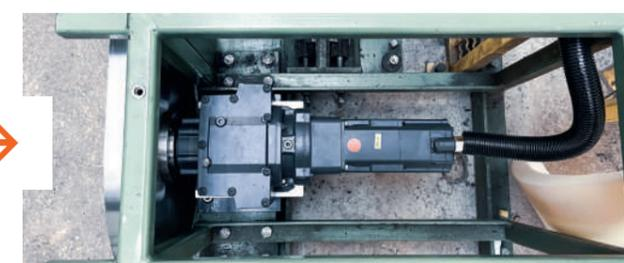
AC Austauschmotor Schneidaggregat
